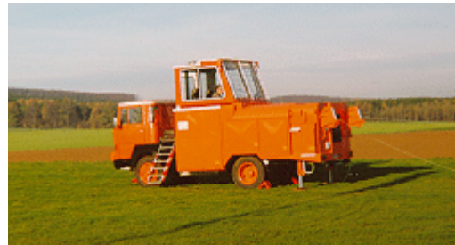
Die Seilwinde (320 PS, 1200 m Seil)
